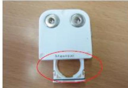
④センサと専用USBケーブルを接続します。
