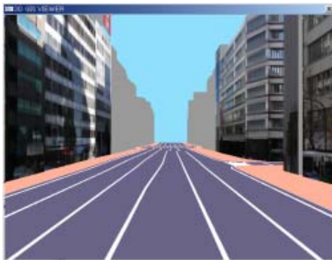
図 2.1.1-3 遠方のオブジェクトを簡略化して表示した例 (建物形状は Mapcube を使用しています。)
