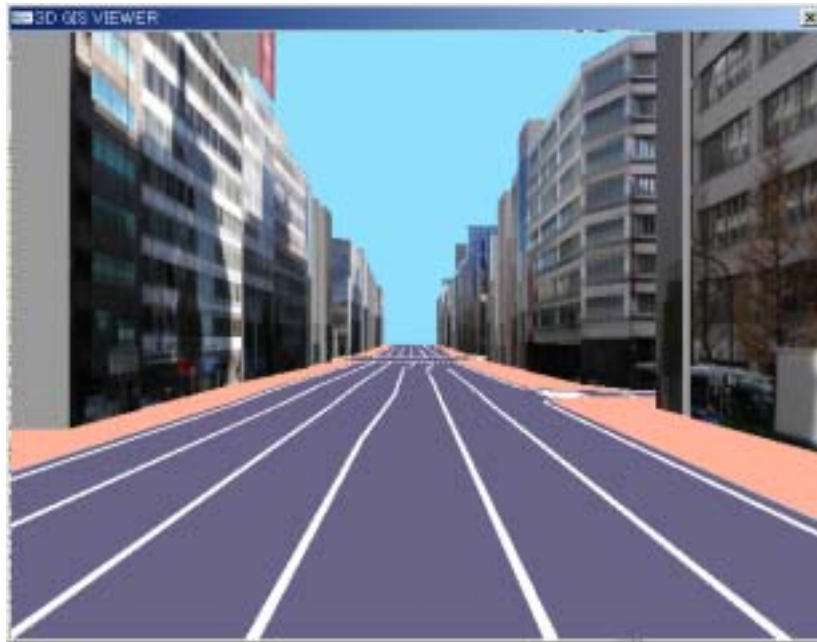
図 3.1.1-26 すべての建物にテクスチャを貼った例 (建物形状は Mapcube を使用しています。)
