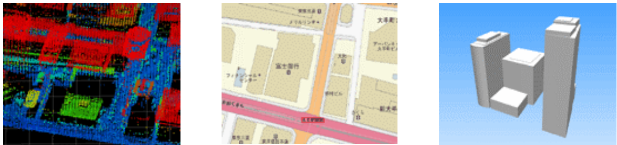
図 1 28 レーザ測量データと 2 次元ベクター地図による建物 3 次元 CAD モデルの生成
