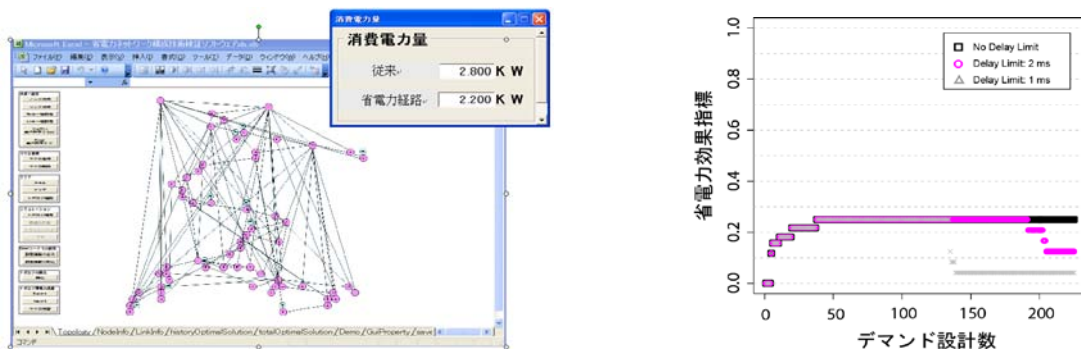
図 3-2 評価例(左:画面イメージ、右:エンドツーエンド遅延制約に基づく省電力効果)
