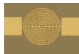
図 3.5.5 偏光方向無依存型のナノフォトダイオード
