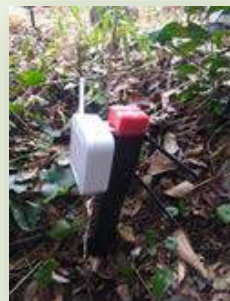
がけ崩れセンサの 設置・実証 (熊本県山江村)
