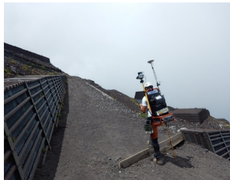
登山道3D地形計測状況 ＜レーザー計測器＞
