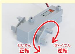
DCモーターの速さは0～100の間の数字で設定できますが、20より小さい数字を設定するとDCモーターに流れる電気が足りなくなって動かなくなります。
