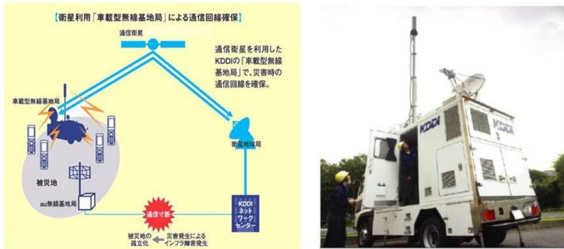
図表 2-2-5 移動基地局車や可搬型衛星基地局キット等の増強事例
