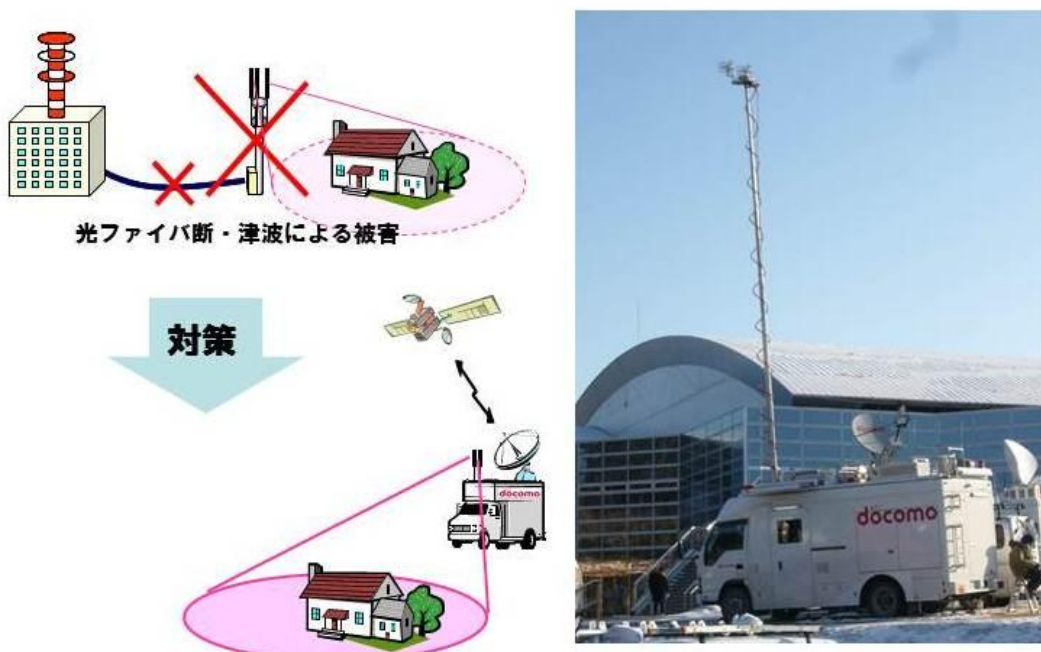
図表 2-1-3 主な設備復旧対策（衛星回線による設備復旧）
