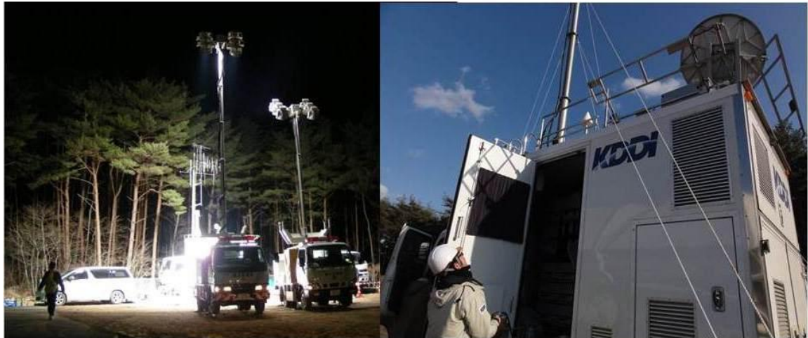
図表 2-1-7 基地局の復旧活動事例（移動基地局車補完：衛星フェムトセル）
