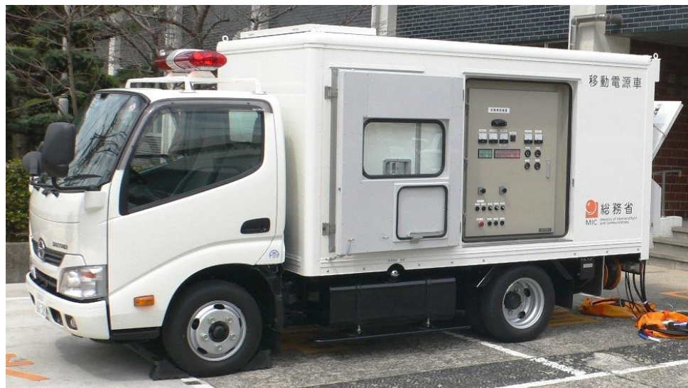
図表 2-2-3 移動電源車の導入事例
