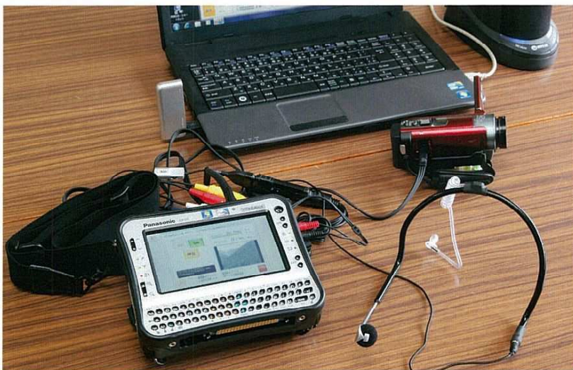
送信と受信に必要な機材一式。音声による双方向のコミュニケーションも可能
