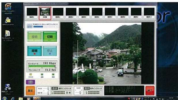
Smart-telecaster Multiの画面。受信側では最大10個の画像を同時に表示し、そのうち一つを拡大表示できる
