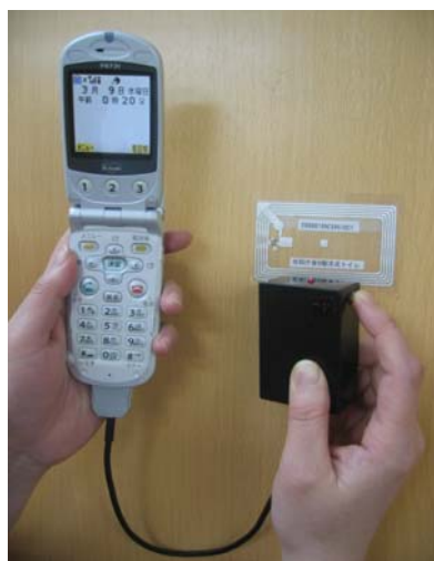
トイレのドアに貼り付けた電子タグをリーダーで読み取る
