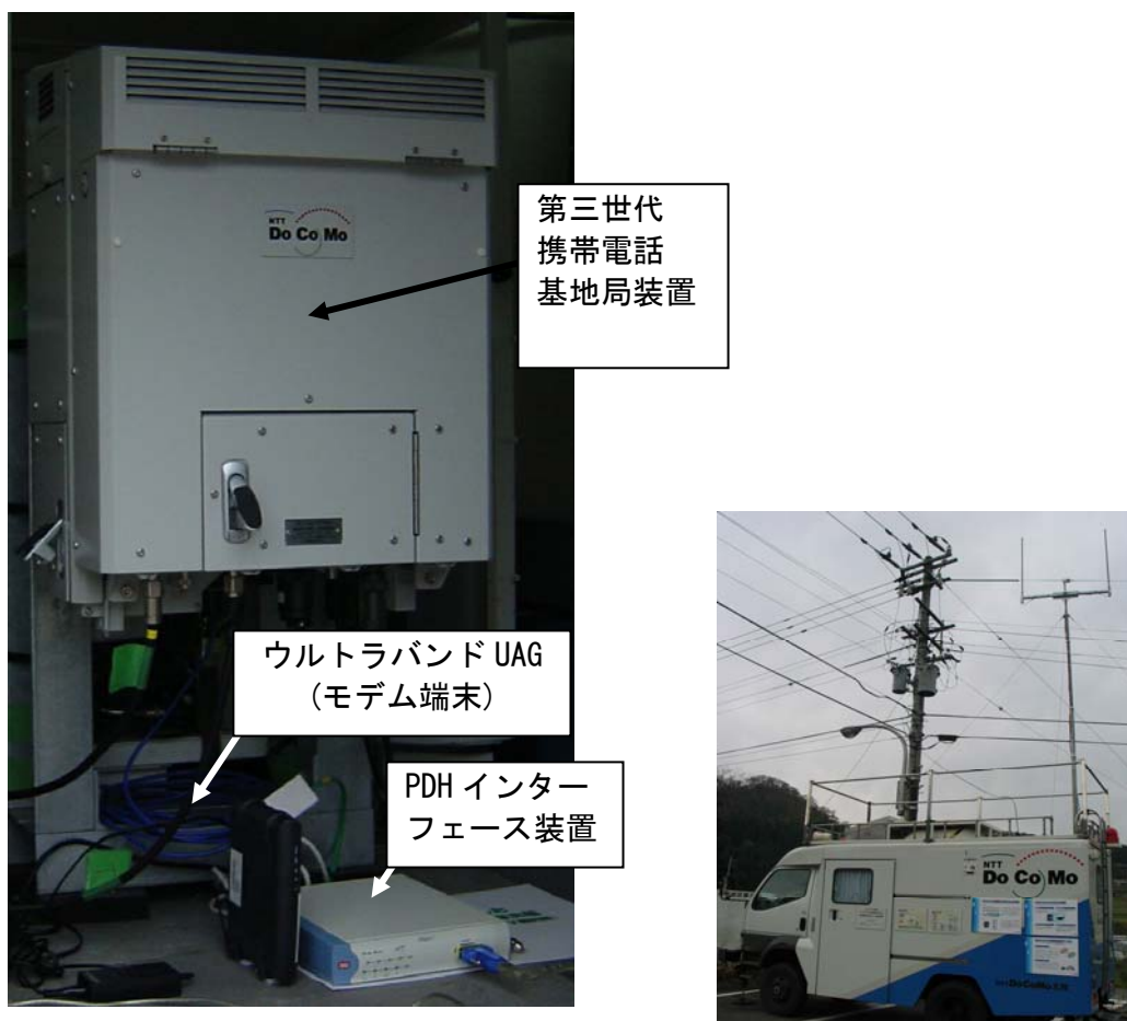
図 6-8 基地局設置車内の基地局装置、ウルトラバンドUAG装置及びPDH-I/F装置
