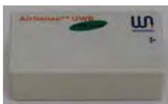
写真 3.1 ローバンドUWB装置
