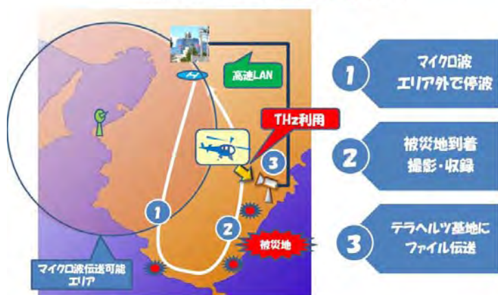
テラヘルツを利用した映像伝送イメージ (被災地がマイクロ波伝送エリア外の場合)
