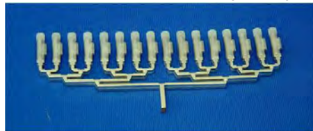
40GHz帯16素子樹脂射出成形 導波管ホーンアレーアンテナ
