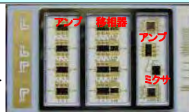
開発した受信モジュール (25.6mm×54.4mm×3.9mm)
