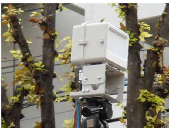
図 3-1 ミリ波センサ（試作機）
