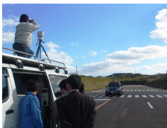
図 3-2 自動車の検知試験
