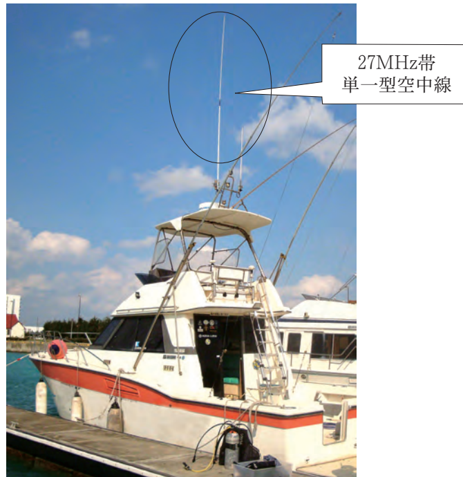
写真 3-4 移動局外観と空中線設置状況
