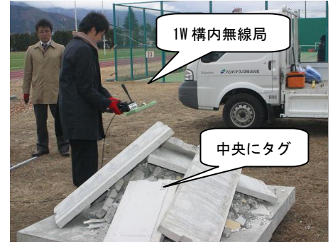
【瓦礫を模擬しての電波伝搬実験②】
