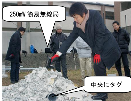
【瓦礫を模擬しての電波伝搬実験①】
