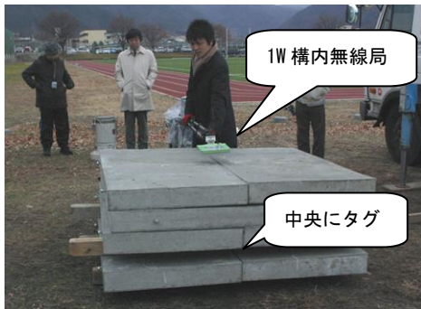
【コンクリート板を使用した電波伝搬実験】
