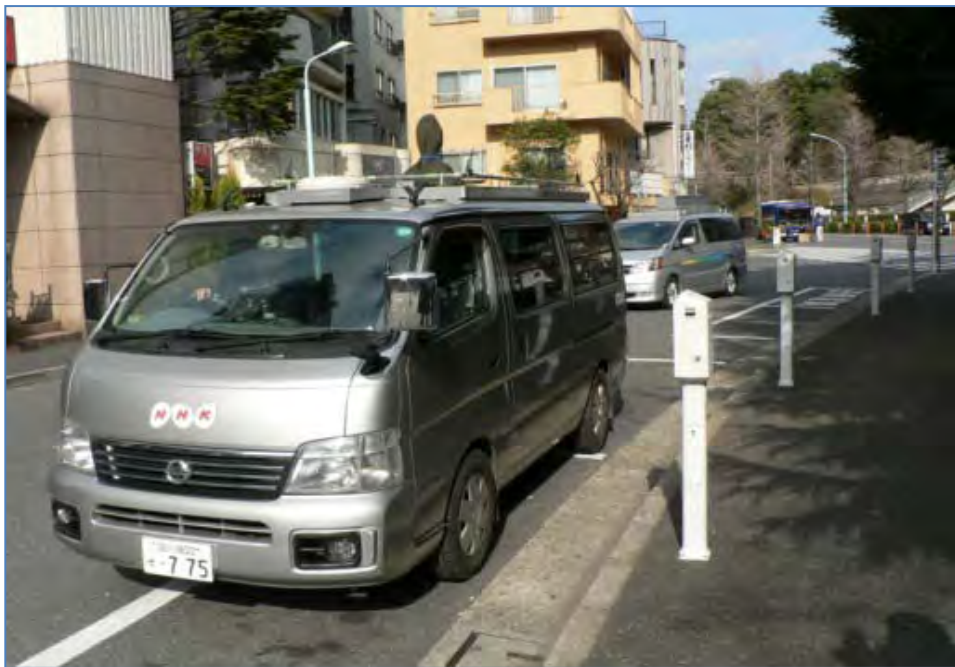
天井4隅にアンテナを設置した測定車
