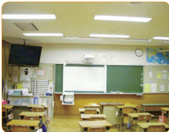
黒板取付型により教員の活動スペースを確保した例 (尚英中学校)
