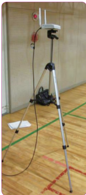
避難所となる体育館に臨時に設置された無線LANアクセスポイントの例 (藤の木小学校)
