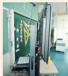
児童に背を向けずにPCを操作するためPCをインタラクティブ・ホワイト・ボードの背面に設置できるようにした例 (紅南小学校)
