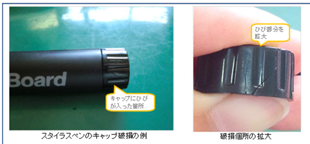
図 5-4 IWB スタイルスピンのキャップ破損例
