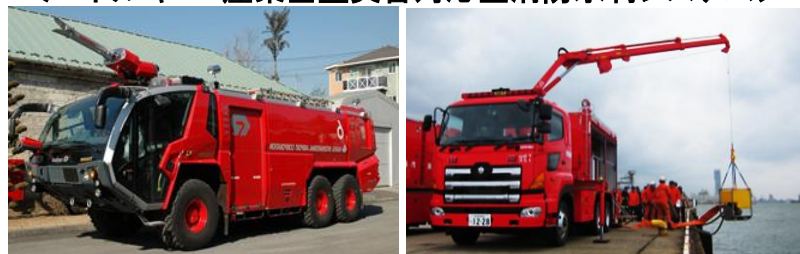
大型放水砲搭載ホース延長車
