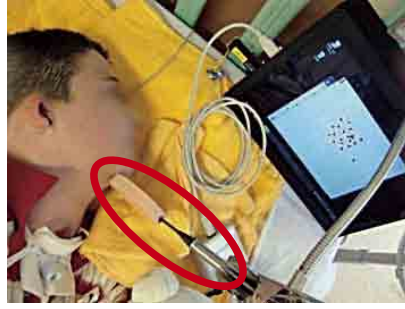
顎でレバー式スイッチを操作している例
