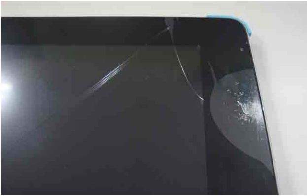
ペンがタブレットPCに当たって破損した例
