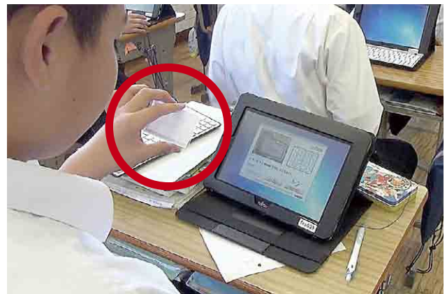
カラービットが印刷されたカードをカメラにかざしてログイン認証している例 (尚英中学校)
