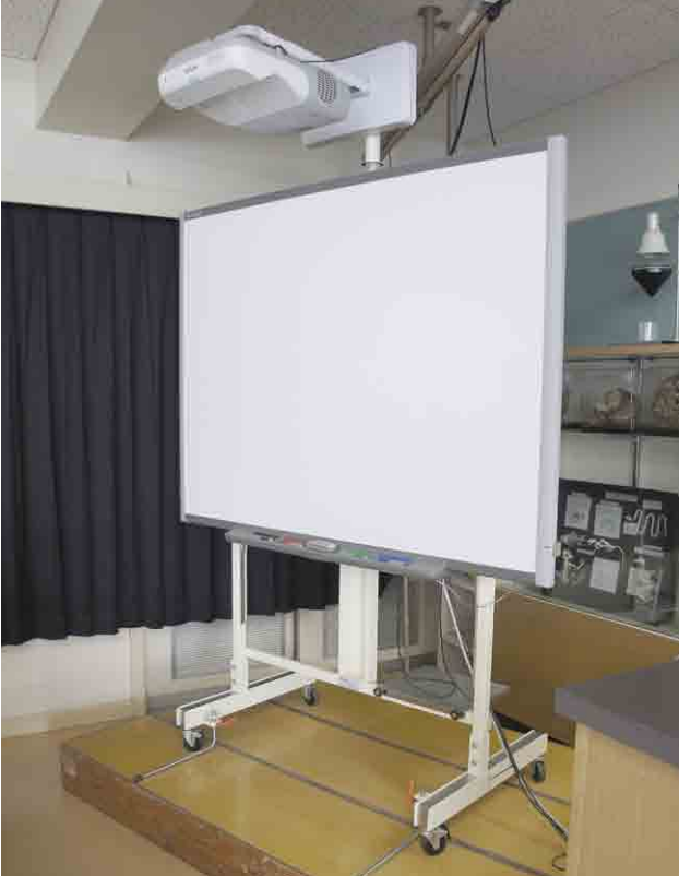
転倒防止対策を行った上で台の上に電子黒板を置いた例 (武雄青陵中学校)
