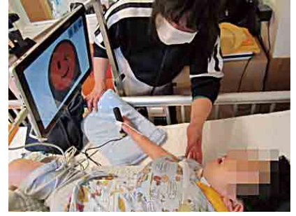
手で握ってグリップ式スイッチを操作している例
