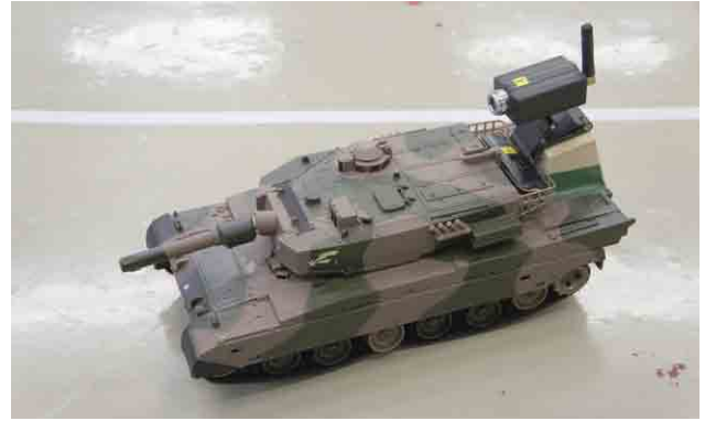
カメラが取り付けられたラジコン車
