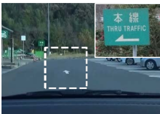
〈休憩施設駐車場〉本線方向案内標識設置、矢印路面標示
