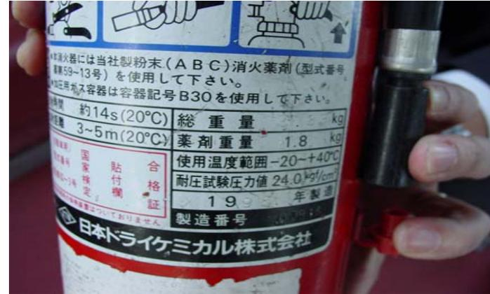
写真② (1988 年製造で消火薬剤が詰め替えられていない)
