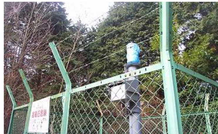
雨量計の周囲三方向が樹木に囲まれ、距離が10メートルに満たないことから、風向風速によって雨量観測に影響
