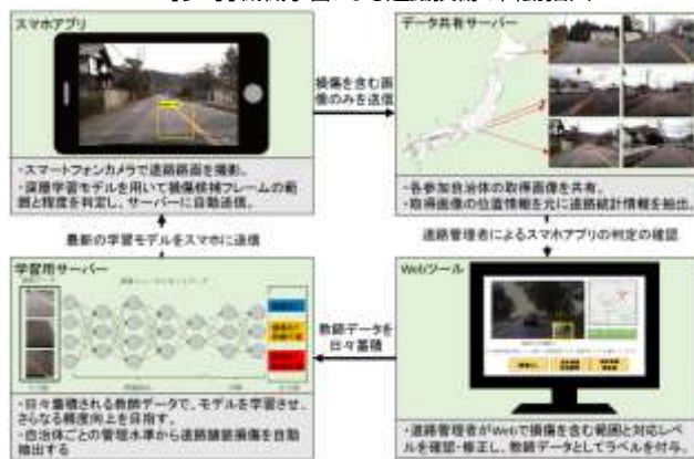
【参考】機械学習による道路損傷の自動抽出
