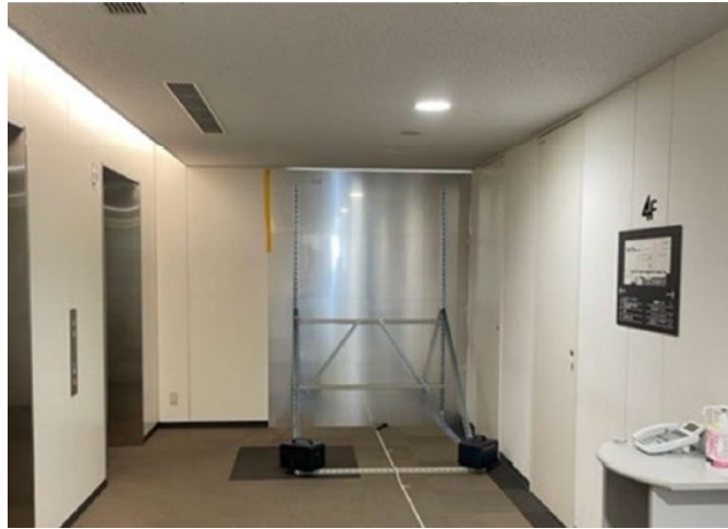
図 2-10 アルミ板による遮蔽による測定環境（案件番号 R4-28）
