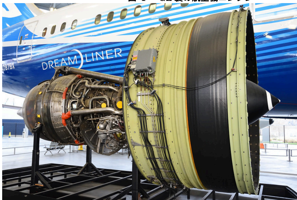
図 1 GE 製の航空機エンジン
