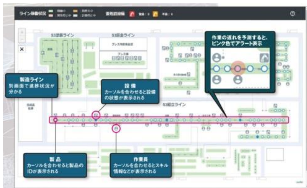
図表：ダイキン工業が構築した空調機工場のデジタルツイン
