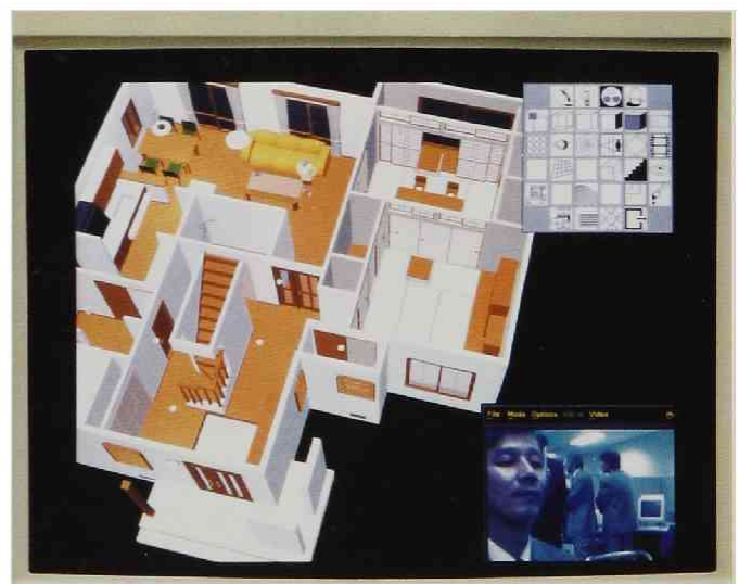
3次元CGを利用した対話型住宅設計システムの端末画面
