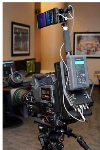
ショルダーカムコーダー『PXW-Z450』にトランミッター試作機、Xperia 5Gミリ波対応デバイスを搭載したカメラシステム
