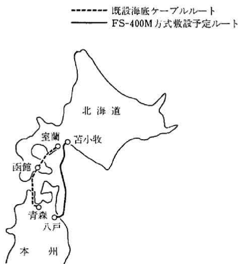
第1—2—13図 青森県八戸—北海道苫小牧間海底光ファイバケーブルの敷設予定ルート
