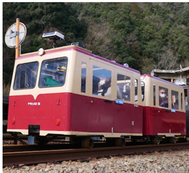
2021年 2号車が完成し、連結及び総括制御が 可能になり、パワーが2倍に！
