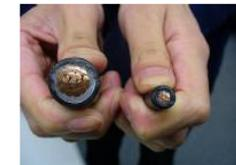
高電圧化することで配線ケーブルを細くすることができ、作業性を上げられる
