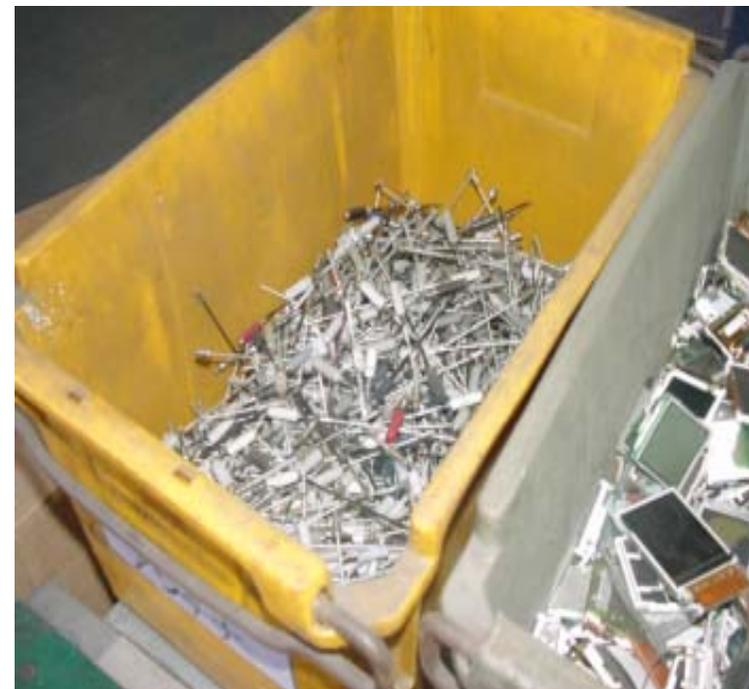
移動通信事業者個別の取組として、可能な限り素材を再資源化するため、リサイクル作業の前工程に回収された端末の手分解作業を導入
