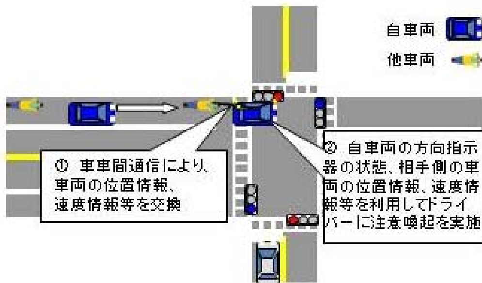
図 3.1-4 左折時衝突防止の利用イメージ例
