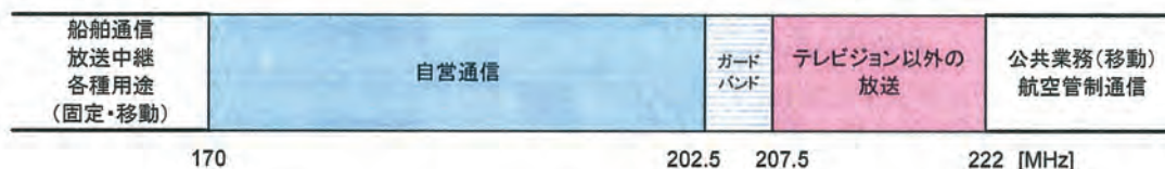
図 1.1-1 マルチメディア放送システムと自営通信システムとの干渉形態
