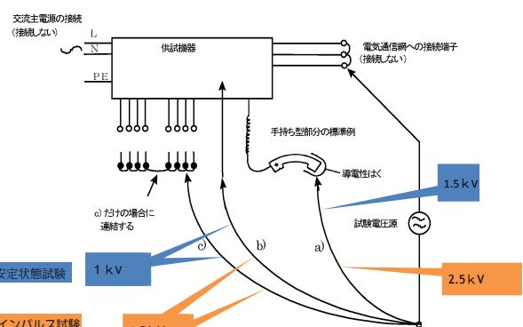
図 4-10 電話用機器の測定箇所の例
