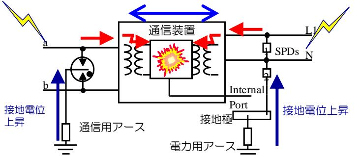
図 4-1 電位差発生の仕組み
