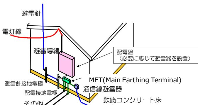
図 4-3 建築物における TT システム接地系統の共通接地
