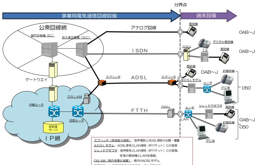
図 1-2 固定電話に関する設備構成例
