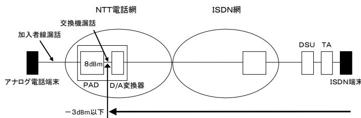
図 3-1 ISDN 端末の規定の概要
