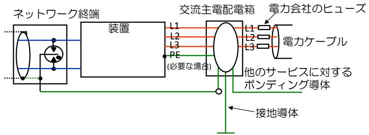
図 4-2 TT システム系統の共通接地
