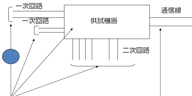
図 4-9 絶縁耐力の測定箇所の例
