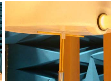
ダイポールアンテナを用いた簡易性能試験
