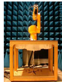
ダイポールアンテナを用いた簡易性能試験
