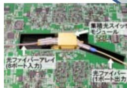
世界初の超小型集積光スイッチモジュール (1/9の小型化、1/2～1/3の省電力化、100万倍の高速化)
