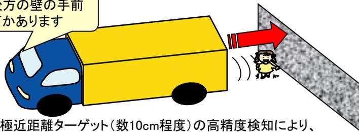
極近距離ターゲット(数10cm程度)の高精度検知により、後方の高度な安全確保を実現。(壁と分離して子供を検出)
