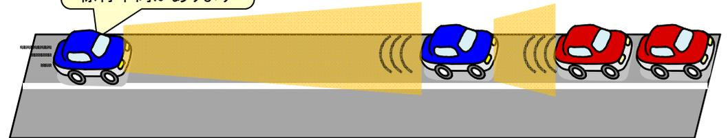
短距離(数10cm)から遠距離(数100m)までのターゲットの距離及び速度を高精度で検知することで、追従走行や渋滞時追突防止に必要なきめ細かい車間距離制御を実現。
