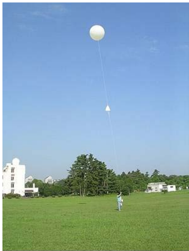
図 1.3.2-3 ラジオゾンデの飛揚形態
