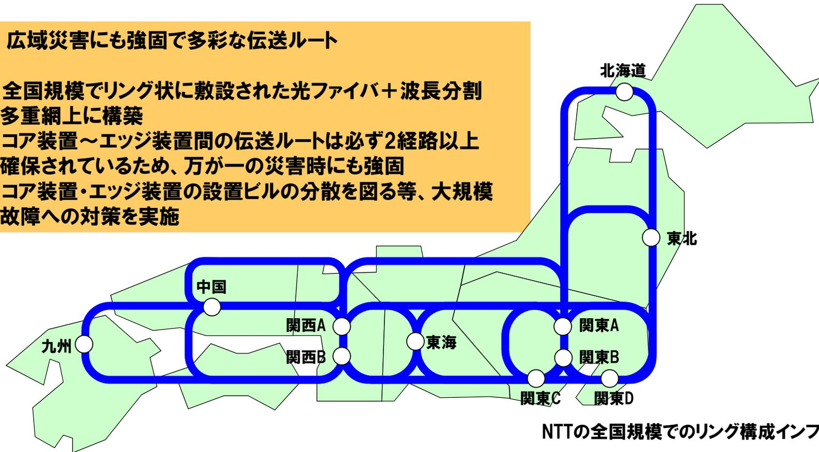
リング状に構成された豊富な設備で中継伝送路区間の二重化と自動切替を実現
