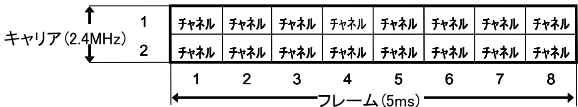
図 4. 2-1 sPHS 方式チャンネル構成
