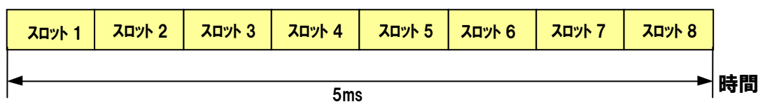
図 4. 2-2 sPHS 方式のスロット構成
