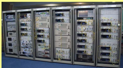
世界最高速光パケットスイッチ (1.28Tbps/port)
