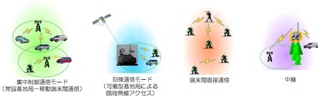
図 1.4.3-1 公共ブロードバンド移動通信システムの通信形態
