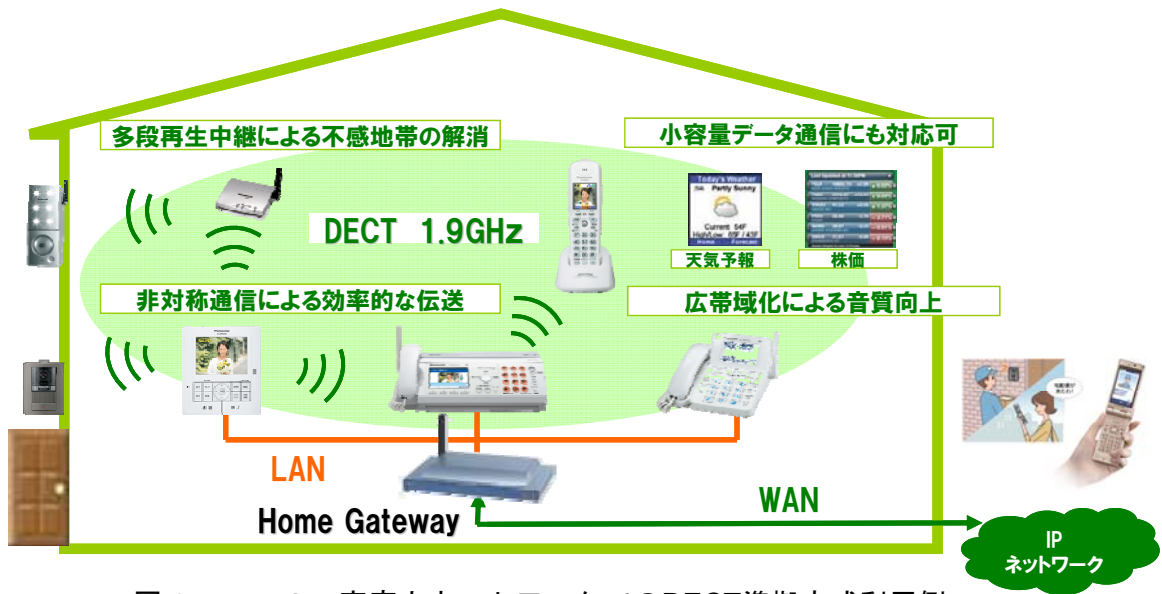
図 1. 4-6 家庭内ネットワークでのDECT準拠方式利用例
