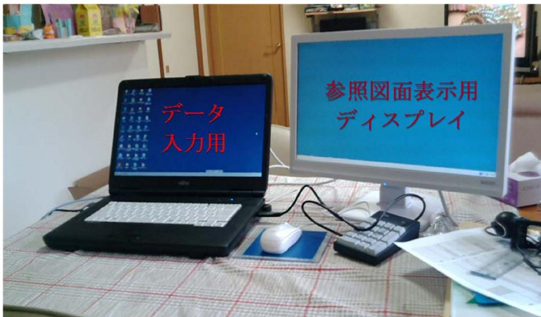
図 3.1.4-8 図面参照用外部ディスプレイを接続したシンクライアント端末
